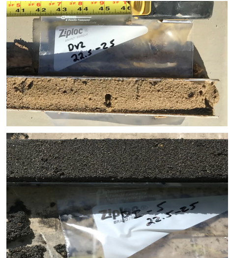
La foto in alto mostra un campione di terreno prelevato prima dell'applicazione di PetroFix. La foto in basso mostra un campione di terreno prelevato dopo l'applicazione di PetroFix, in cui si osserva un suolo nero dove il PetroFix è stato distribuito correttamente
