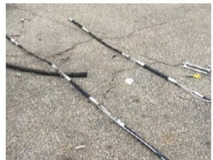
Fig. 6: Tubazioni per postazione fissa valvolata (sopra) e doppi packer per iniezione in postazione fissa valvolata (sotto)
