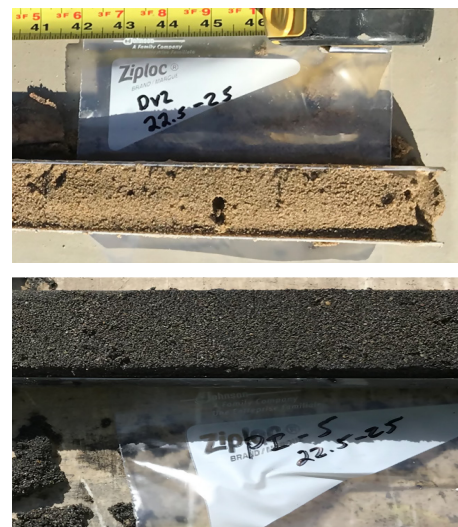
Fig. 11: Arriba: una muestra de suelo tomada antes de la aplicación de PetroFix. Abajo: una muestra de suelo tomada después de la aplicación de PetroFix, en la que se observa un suelo negro donde el PetroFix se ha distribuido correctamente.
