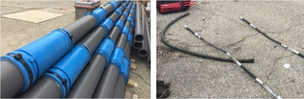
Fig.5: Tuberías para puntos fijos con válvulas (izquierda) y obturadores inflables dobles para inyección en puntos fijos con válvulas (derecha)
