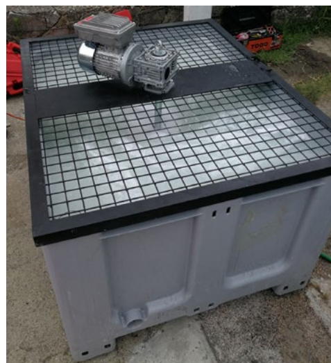
Fig. 1 RegenOx Part A nella vasca di miscelazione.
